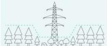
Von März bis in die Sommermonate 2018 werden entlang des künftigen Leitungstrassees weitere Rodungsarbeiten ausgeführt. Diese sind für den sicheren Betrieb der Leitung notwendig. An den Maststandorten wurden dafür die Flächen dauerhaft gerodet. Entlang der Leiterseile wird ein Korridor von 30 m Breite freigehalten. In diesem Bereich werden tiefstämmige Bäume im Rahmen der Niederhaltung angepflanzt. Zu diesem Zweck mussten die hochstämmigen Bäume gerodet werden.
