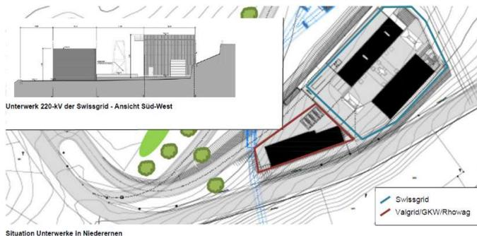
Der neue Standort des 220-kV Unterwerks von Swissgrid in Niederernen befindet sich westlich vom Kraftwerk der Rhonewerke (Rhowag). Westlich zum 220-kV-Unterwerk der Swissgrid wird ein 65-/16-kV-Unterwerk der Valgrid gebaut. Die Unterwerksareale werden mit einer neuen gemeinsamen Strasse ab der Kantonsstrasse erschlossen.
